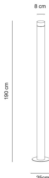
El pie de salón LED POLE es una luminaria de formas limpias, un cilindro vertical de casi dos metros de altura que emite luz hacia arriba a través de un difusor en su parte superior.
